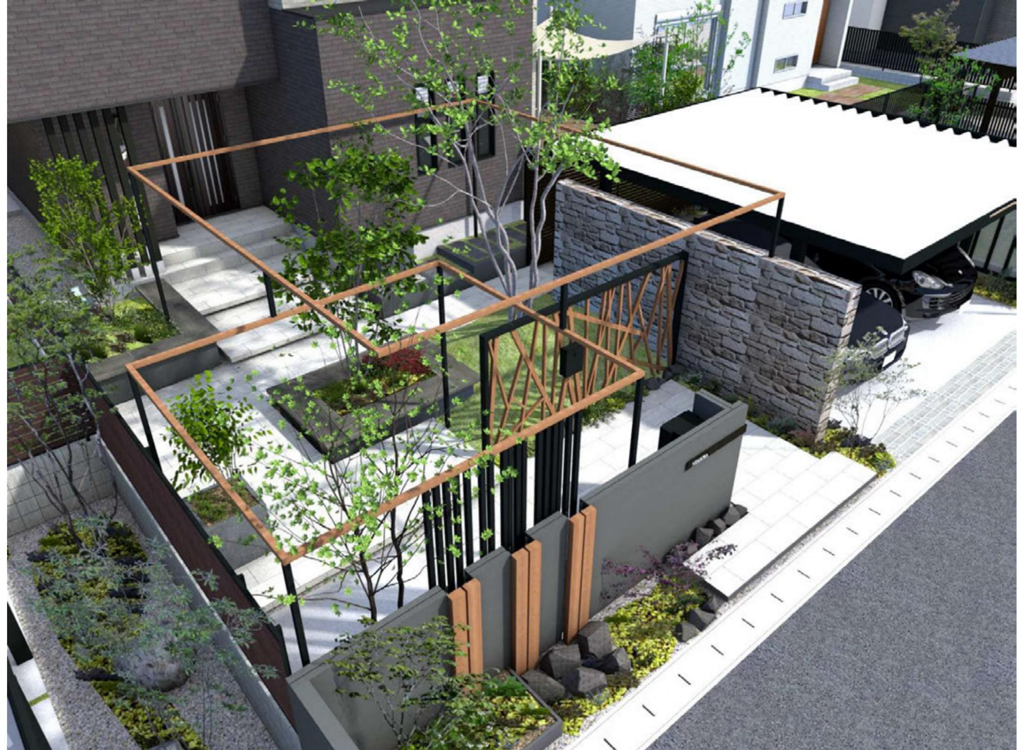
乱格子の門壁が目立ち浮いてしまわぬよう線を取り入れたものを全体に配置しようと考えた。スクエア型の構造物は、蹴込階段の浮遊感を用いてデザインをした。建物は縦のラインが強いため、外構では横ラインを意識し、使用することにした。横ラインだけでは味気なく感じてしまうため、角柱を立てバランスをとるようにした。
